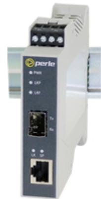
Perle **SRS-1110-SFP für die Hutschiene** verbinden auf transparente Weise UTP CAT5/6/7 Kupfer mit LWL in Elektrizitäts- und Umspannwerken. Mit einem Betriebstemperaturbereich von **-40°C bis + 75°C** und Zertifizierungen für IEC 61850-3, IEEE1613 und EN 61000-4-16, erfüllen LWL-Ethernet-Konverter alle Anforderungen, die für den sicheren Betrieb in den rauen elektrischen Umgebungen im Zusammenhang mit Stromversorgungs- und Umspannstationen erforderlich sind.
